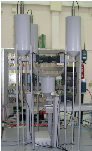
Fig. II-2 - Posto de doseamento e pesagem.
